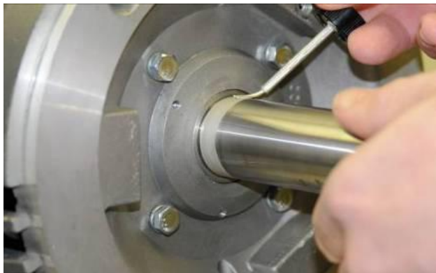
Fig. 4 - Înainte de instalarea unui inel de protecție, arborele motorului trebuie bine curățat de orice material izolator, până la metal. Conductibilitate se va îmbunătăți prin acoperirea cu argint coloidal a suprafeței de contact a arborelui cu microfibrele inelului.
